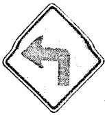
Curva Acentuada à Esquerda
