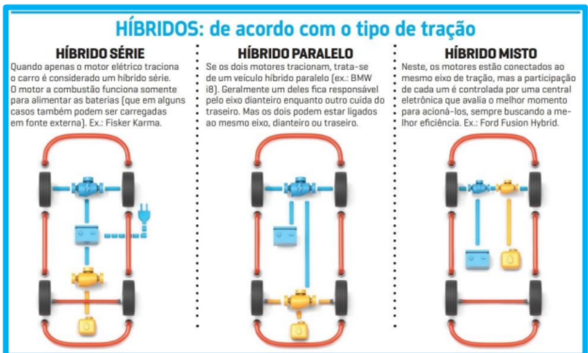
Figura 2 – Classificação dos HEV de acordo com o tipo de tração (Fonte: Jonatan Sarmento/Quatro Rodas)
