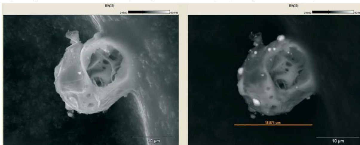
Figura 2: partícula de GSR cavitada disparada por fuzil FAL. Imagem gerada por elétrons retroespalhados.
