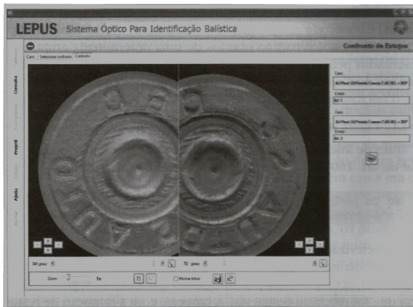
Figura 4: Imagem do confronto de dois estojos pelo sistema LEPUS Sistema Óptico para Identificação Balística.
