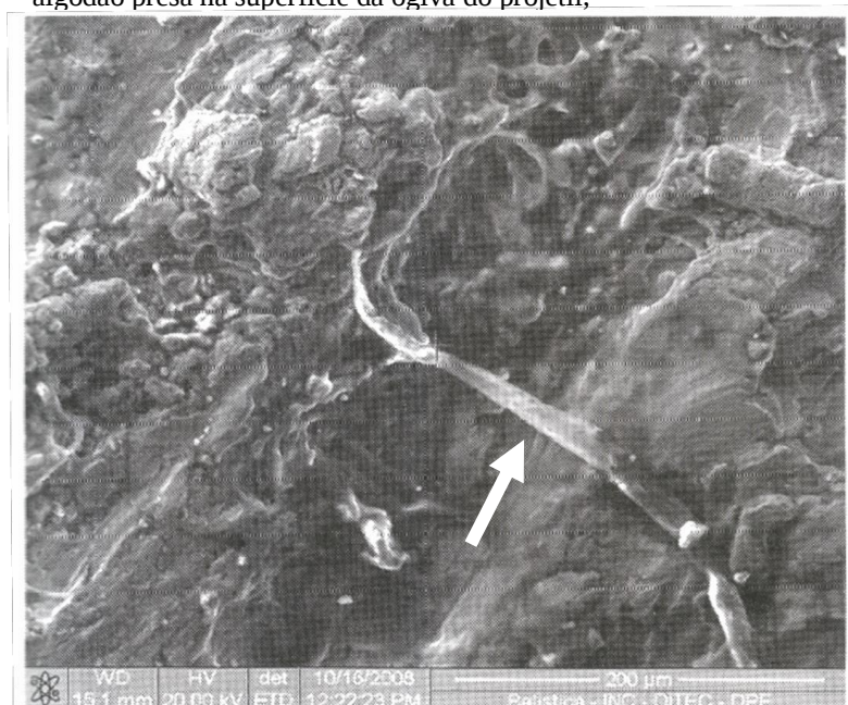
Figura 9: Fotomicrografia apresentando a morfologia da fibra de algodão presa na superfície da ogiva do projétil,
