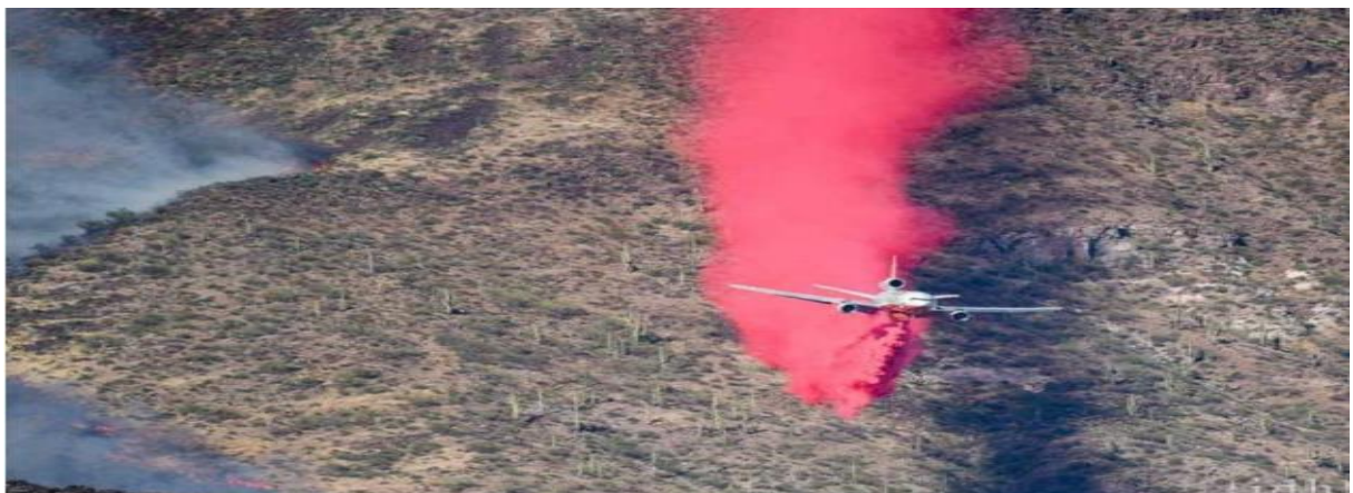
Figura 2: Aeronave criando barreira química por meio do método indireto de lançamento de retardante de chamas
