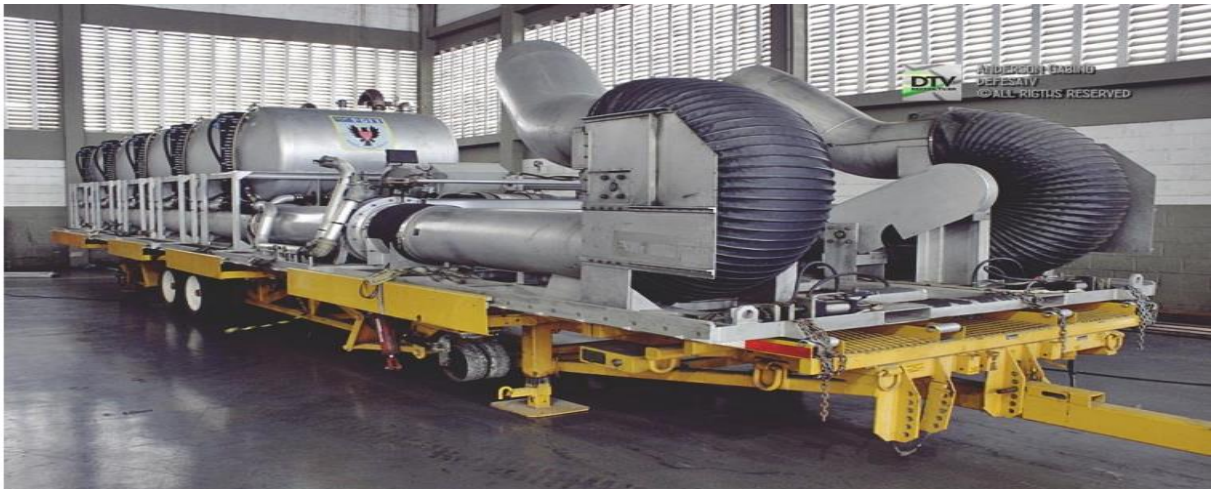
Figura 6: Sistema MAFFS utilizado pela Força Aérea Brasileira
