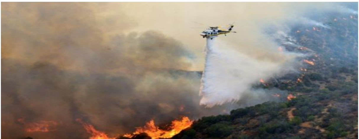
Figura 1: Helicóptero realizando lançamento paralelo ao perímetro do incêndio conforme o método paralelo.
