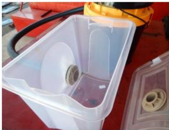
Figura 11.2 – Detalhe da tela de retenção na caixa de captura (Fonte: Comissão)
