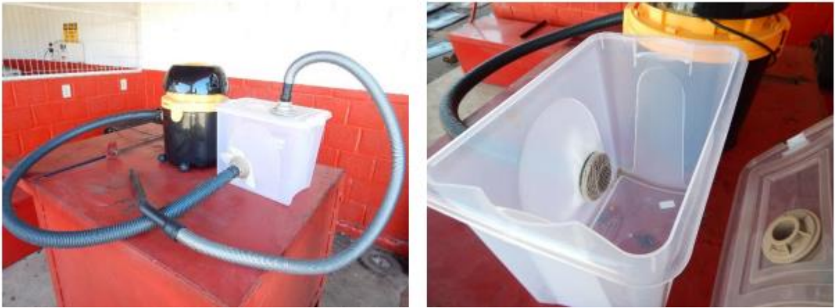
Figura xx e xx.1: Sistema para captura de abelhas feito com aspirador de pó, filtros, vedadores e caixa rígida. (Fonte: Comissão)
