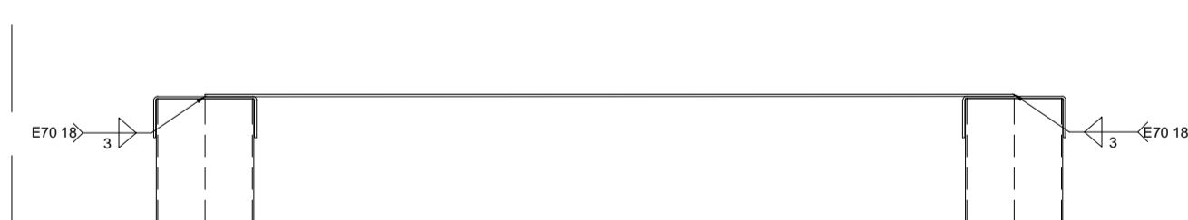
Detalhe do contraventamento
