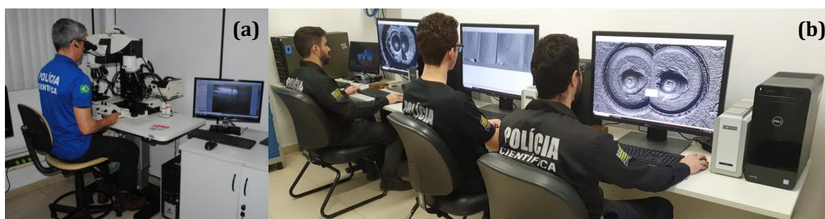
Figura 1 – Ferramentas tecnológicas utilizadas pelo Laboratório de Balística Forense da Polícia Científica de Goiás: (a) Microscópio Comparador Óptico e (b) Sistema de Comparação Automatizada.
