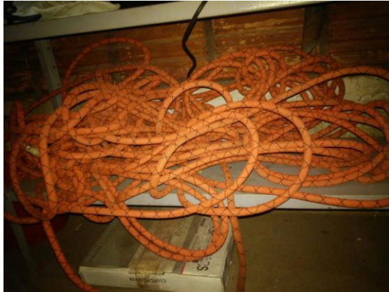
Figura 15: corda mal acondicionada
