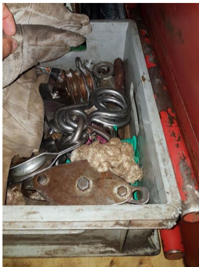
Figura 22: material acondicionado de forma errada
